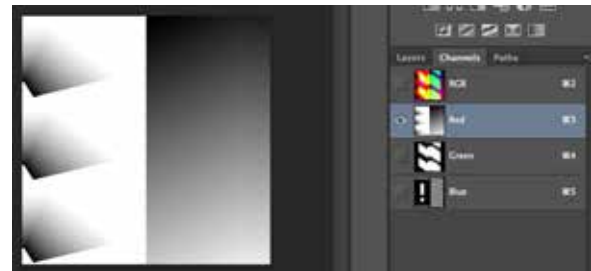
ABB. 20: ALLE BILDER FÜR DIE STRECKE BEFINDEN SICH IN UNTERSCHIEDLICHEN KANÄLEN EINER GEMEINSAMEN TEXTUR
